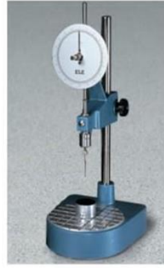
الشكل 7: يوضح جهاز اختبار اختراق البيتومين
