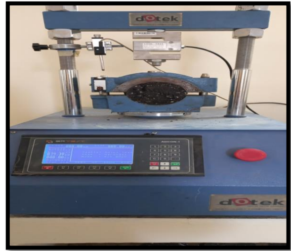
الشكل 6: جهاز تحديد نسبة الثبات والانسياب بطريقة مارشال.
