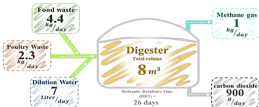
الشكل 10: مخطط توضيحي لمداخلات ومخرجات المفاعل الحيوي
