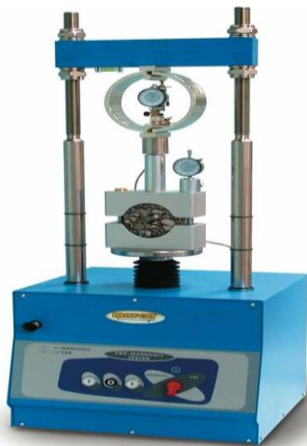
الشكل 6: اختبار مارشال للخلطة الإسفلتية.
