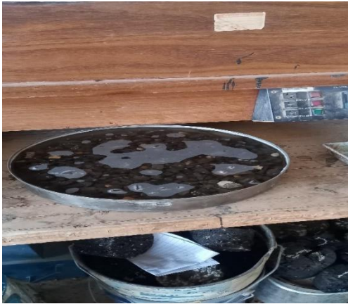
الشكل 2: اختبار الوزن النوعي والامتصاص للركام
