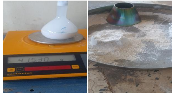
الشكل 4: اختبار التحليل المنخلي والكثافة النوعية للمادة المالئة
