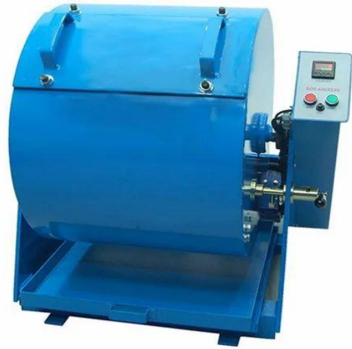
الشكل 3: اختبار مقاومة الركام للتآكل والتفتت
