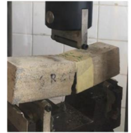
(A) اختبار المقاومة بالشد بالانعطاف
