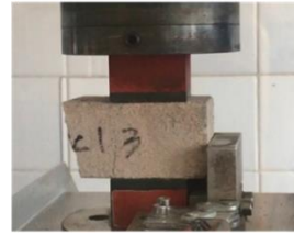
(B) اختبار المقاومة على الضغط
