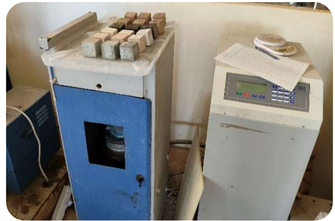
الشكل 2: مكعبات المونة مع جهاز اختبار مقاومة الضغط
